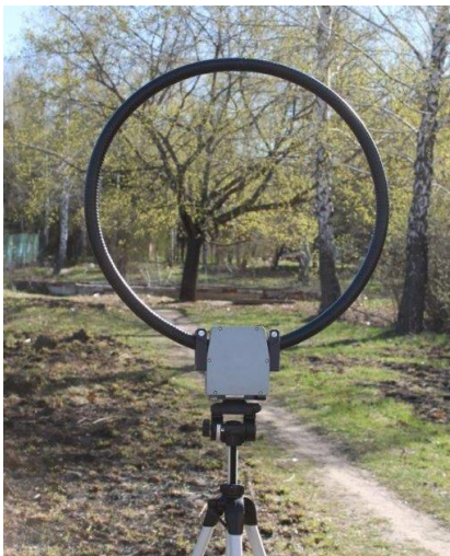
Фото 1. Вариант крепления антенны П6-119 на фотоштатив
